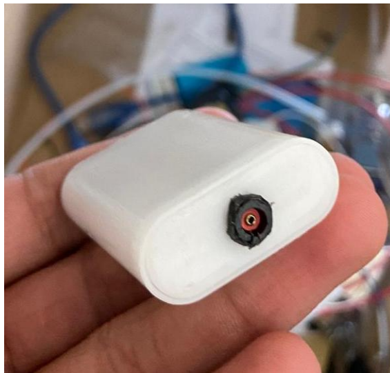
Figure 9 Partie inférieure du briquet avec système de remplissage
