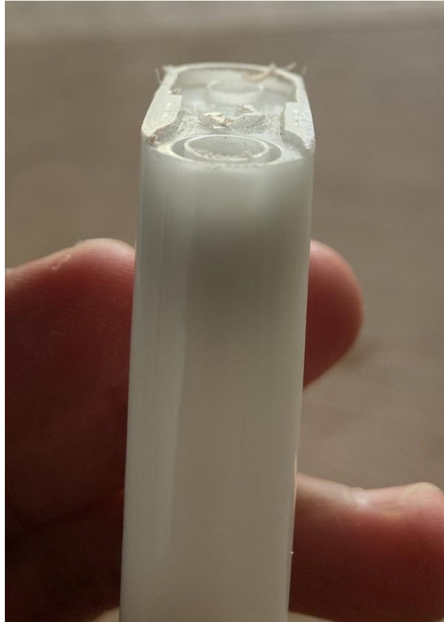
Figure 32 Photographie d'un réservoir correctement poncé
