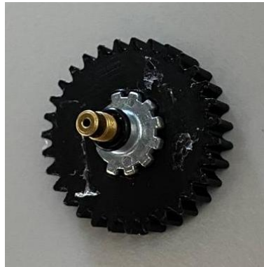
Figure 20 Incrustation de la vis en métal dans un engrenage
