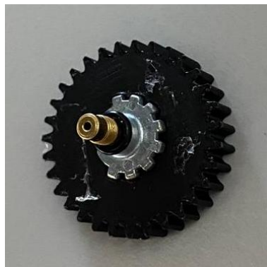
Figure 10 Vis du réservoir et engrenage
